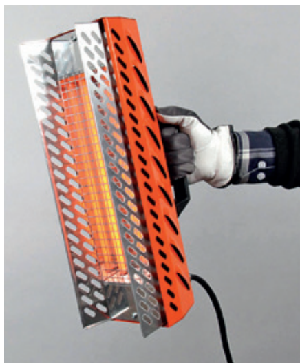
Heizstrahler zur schonenden Farbentfernung
